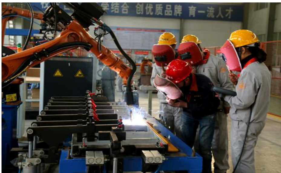
机器人自动焊接现场教学
