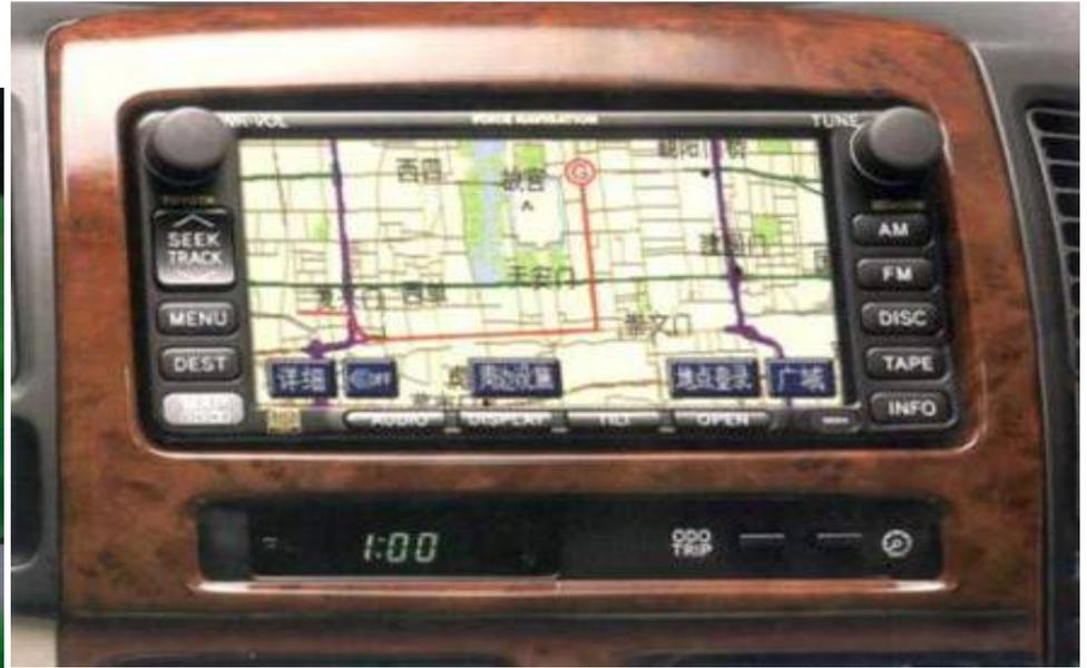
因建筑物和植被等原因，GPS信号会出现中断。此时，由**微型陀螺仪**提供移动角度，结合车辆移动的时间及速度，可计算出方向和距离，以此检查移动车辆的行进路线，作为GPS的辅助导航，直到GPS信号恢复正常。
