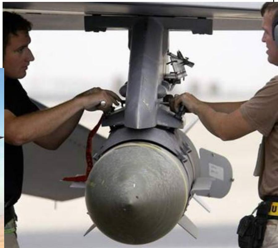
导弹采用GPS定位和**微型陀螺仪**制导，导弹发射后无需人工干预，可以自主飞行，具有多目标攻击能力。这是第四代制导炸弹优于激光制导炸弹的显著特点。
