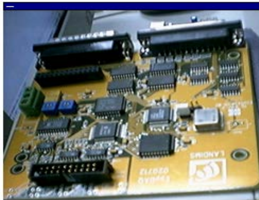
声卡:A/D卡 + D/A卡
