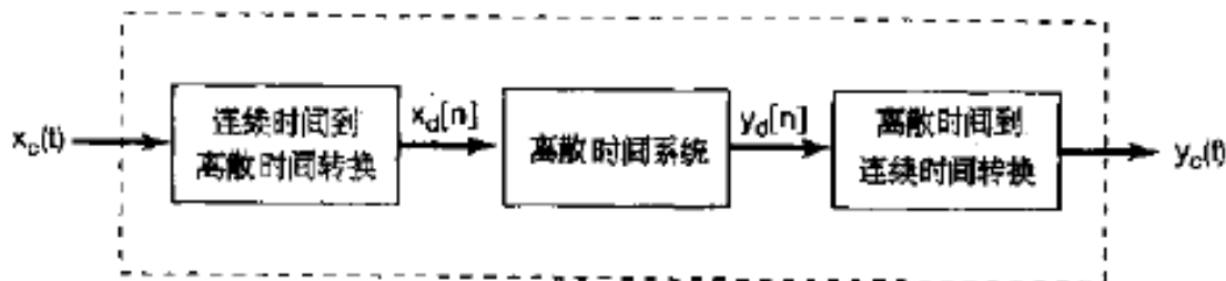
图 7.19 连续时间信号的离散时间处理
