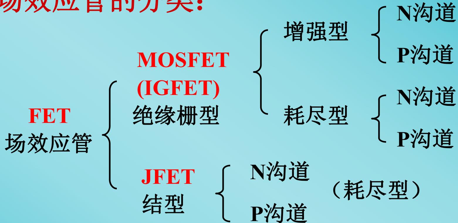
**耗尽型：**场效应管没有加偏置电压时，就有导电沟道存在
