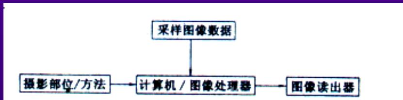
图 11-6 读出灵敏度自动设定机构框图
